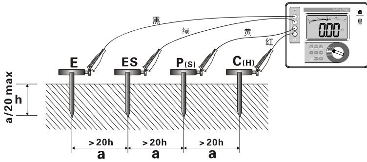
辅助接地棒的间距设置：连接好测试线后，先将转盘旋钮旋至“ **$\rho$  EARTH**”位置，进入土壤电阻率测试模式，长按“**SET**”键(约 3 秒)进入辅助接地棒的间距设置，短按“**SET**”键移动光标，按“**▲**”或“**▼**”键改变当前数字大小(a 值范围:1m~100m)，再长按“**SET**”键保存设定的 a 值，并返回土壤电阻率测试模式。
