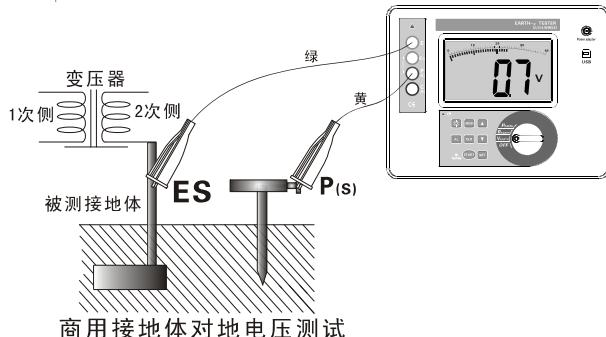
商用接地体对地电压测试
